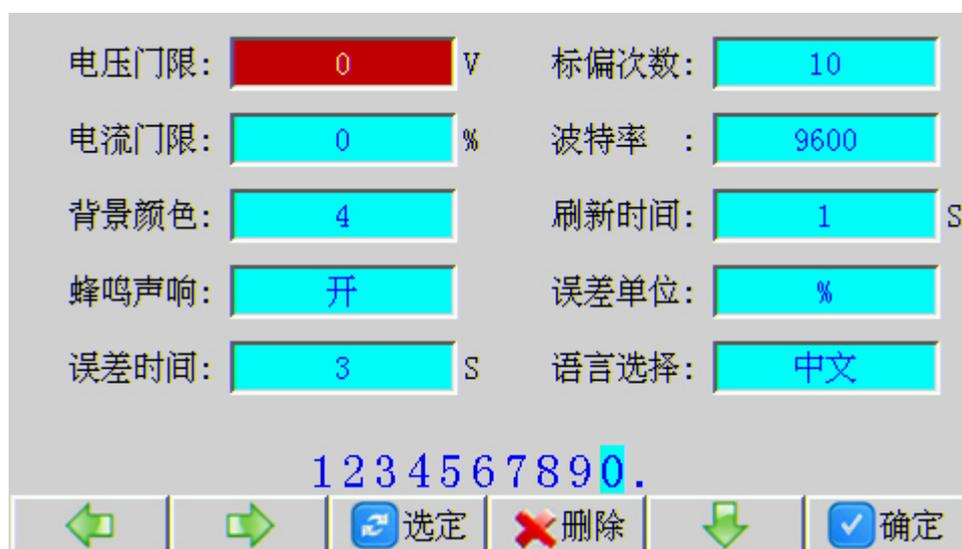
图 6.5.2 仪器系统参数设置界面
