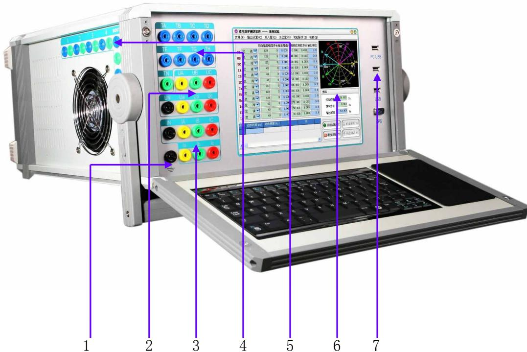
1 机壳接地端口 在测试时应可靠接地，可以提高测试数据的准确性
