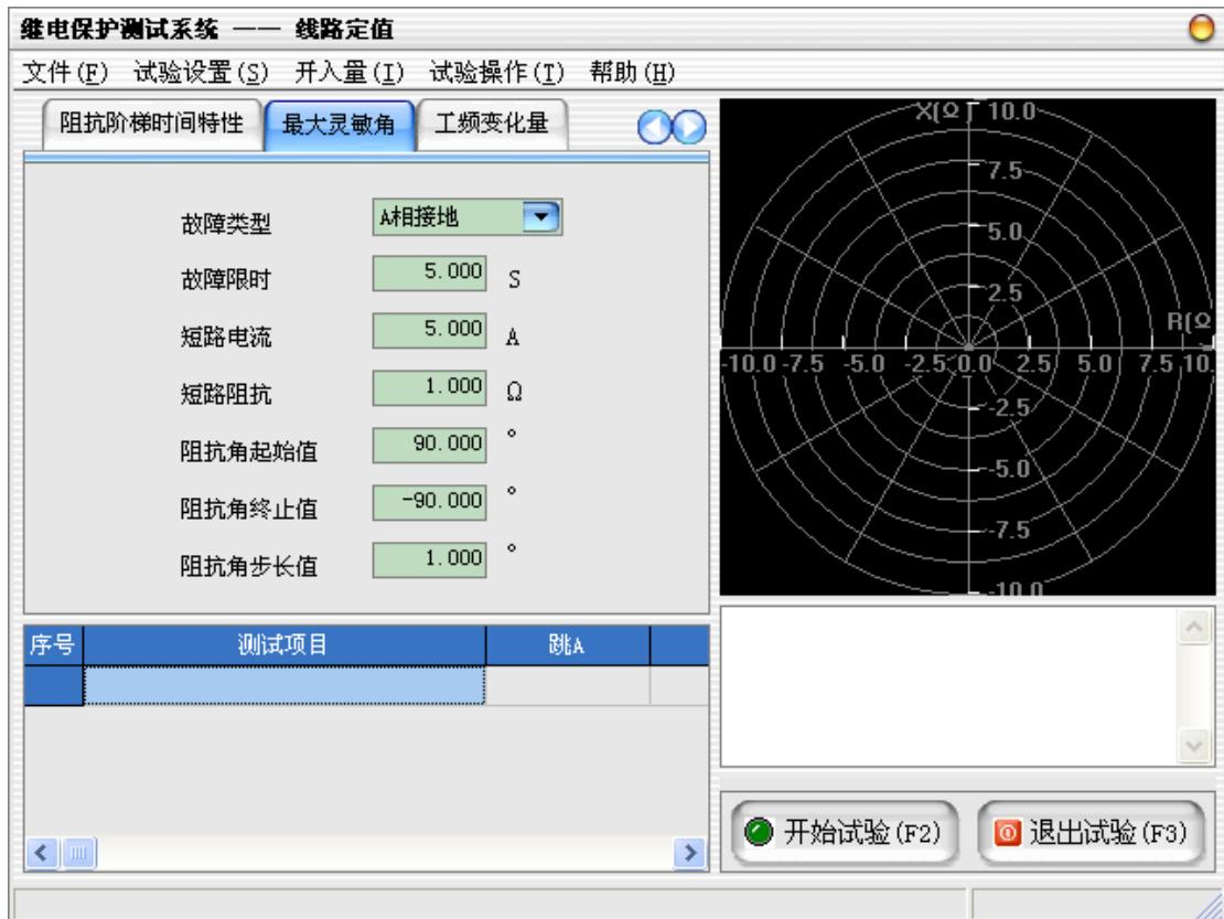
本试验用于测试线路的动作边界和最大灵敏角。各子项目的试验过程见“速断及过流”。
