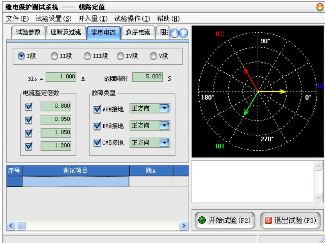
零序保护主要用于线路接地故障的保护，而接地故障中最为典型的当属单相接地，故本试验中以单相接地进行测试。本试验根据测试项目和故障类型的选择，分别由若干个子试验项目构成，各子项目的试验过程见“速断及过流”。
