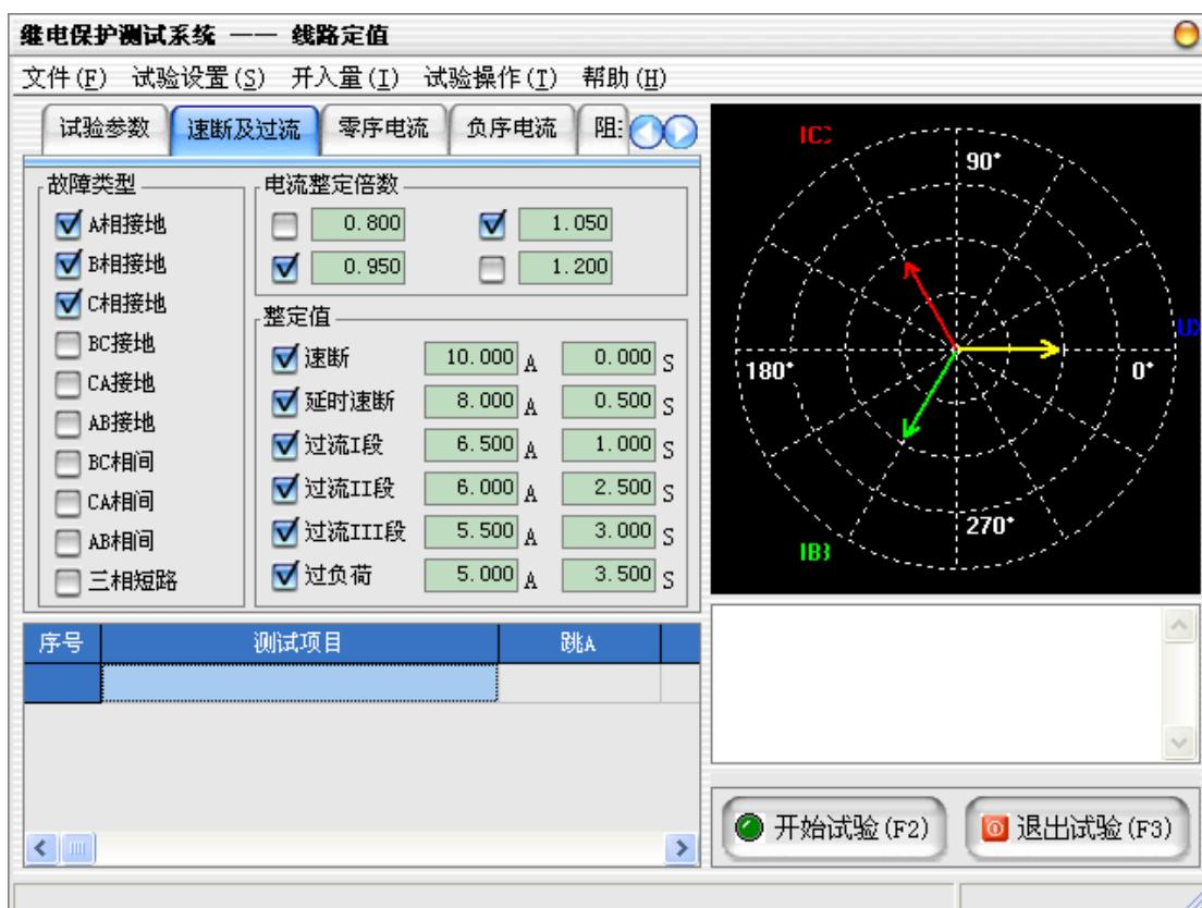
速断及过流测试项目可一次性完成两段速断、三段过流和过负荷的定值、动作时间的测试。各子项目的试验过程分别如下图所示:
