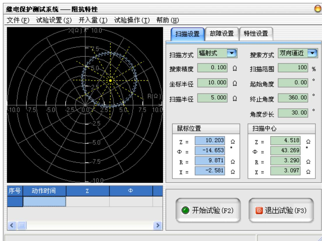
试验中待测试的扫描边界点由扫描角区域和步长决定，此处，扫描角度以平行于R轴为  $0^\circ$ 。例：取扫描角区域为  $0^\circ$  到  $360^\circ$ ，步长为  $30^\circ$ ，则程序自动以  $0^\circ$  为起点，以  $360^\circ$  为终点，按逆时针方向，每隔  $30^\circ$  计算一条扫描线。各扫描线的起点均为中心阻抗Z，长度由扫描半径决定，每条扫描线与整
