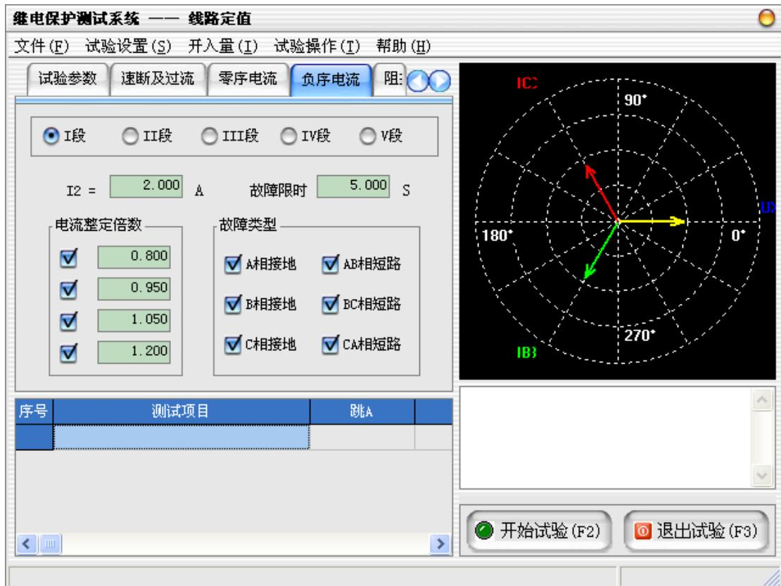
负序电流试验用于分析负序电流保护各段动作的灵敏性和可靠性。各子项目的试验过程见“速断及过流”。
